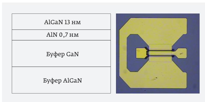
**Рис. 6.** Конструкция гетероструктуры и топология тестового транзистора
